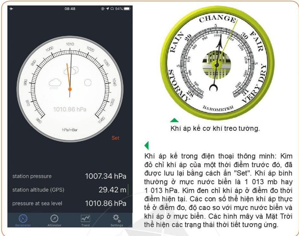
Hình 13.4. Khí áp kế trong điện thoại thông minh và khí áp kế cơ khí treo tường
