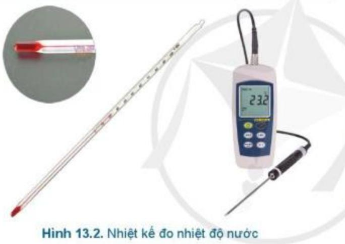
Hình 13.2. Nhiệt kế đo nhiệt độ nước
