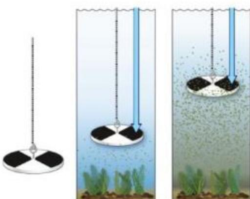
Hình 13.3. Đĩa Secchi đo độ trong của nước
