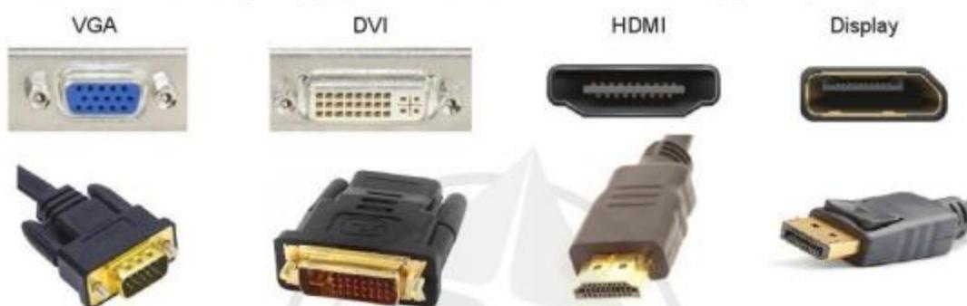
*Hình 3. Cổng và đầu cắm màn hình, máy chiếu*
